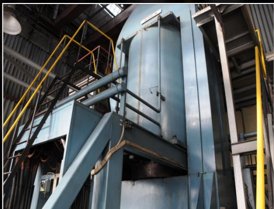
ПРЕСС ГОРЯЧЕГО ИЗОСТАТИЧЕСКОГО ПРЕССОВАНИЯ ABB-ASEA QIH-345 ФИРМЫ «ASEAMETALLURGY» Габариты садки: диаметр 1180 мм, высота 2150 мм. Температура в рабочей камере 1200°C Давление газа в рабочей камере 150 МПА
