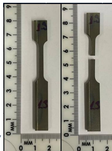
Образец №1.3 до испытаний и после
