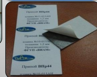
Ленты порошковых припоев на органическом связующем
