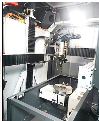
Установка электродуговой наплавки проволоки
