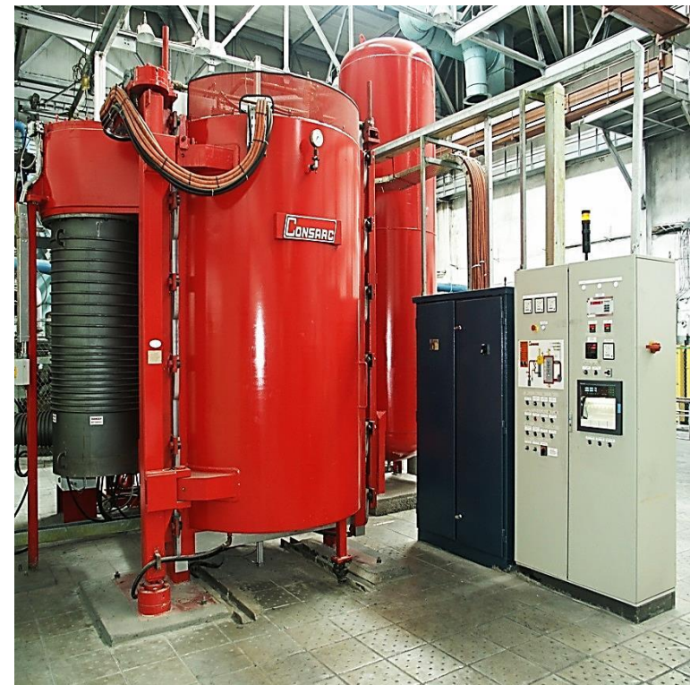
ПЕЧЬ CONSARC С РАБОЧИМ ПРОСТРАНСТВОМ Ø 1210 X 1300 ММ, ТОЧНОСТЬ ПО ТЕМПЕРАТУРЕ ± 5°C
