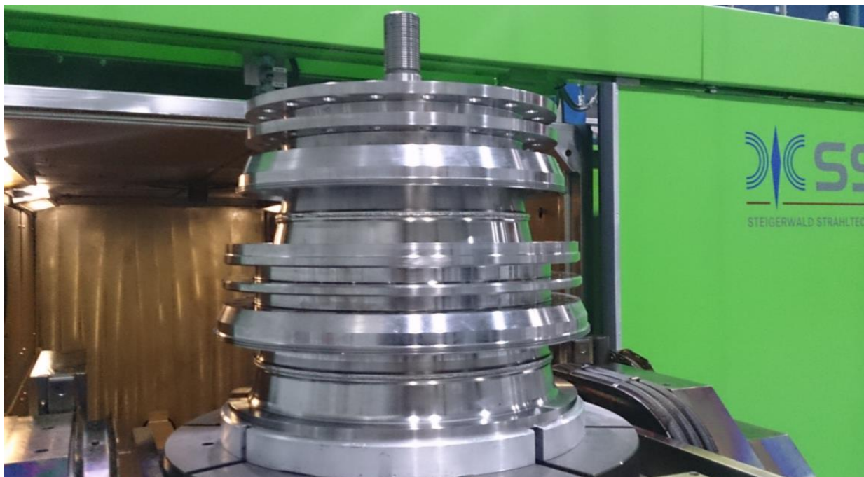
БАРАБАН 1-2 СТУПЕНИ (В ОСНАСТКЕ ДЛЯ СВАРКИ)
