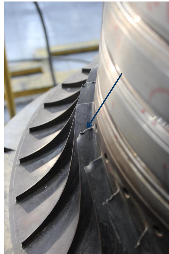
Повреждение крыльчатки ротора морского ГТД
