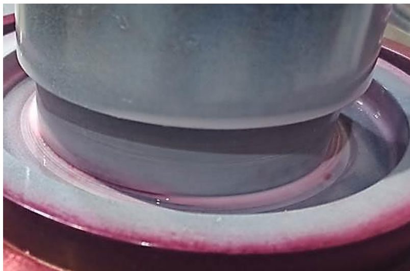
КОНТРОЛЬ ЦД-15В НАТУРНЫХ ОБРАЗЦОВ ДИСКОВ ПОСЛЕ ТЕРМООБРАБОТКИ
