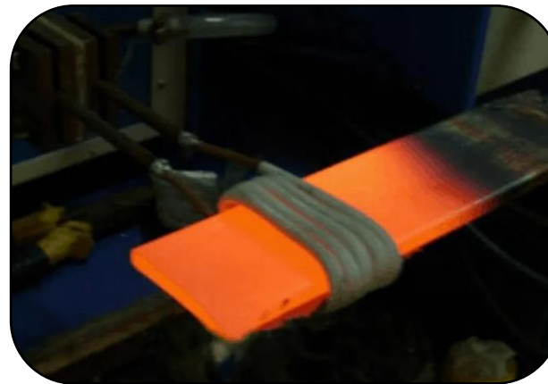
Закалка токами высокой частоты (ТВЧ)
