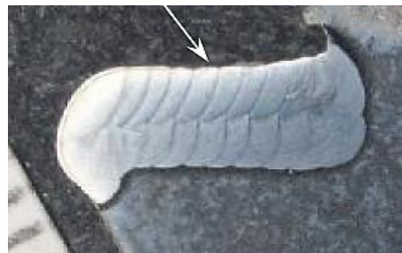
Макроструктура по местам наплавки на лопатке (места наплавки указаны стрелками)
