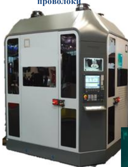
Установка электродуговой наплавки проволоки
