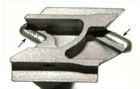
Макроструктура по местам наплавки на лопатке (места наплавки указаны стрелками)
