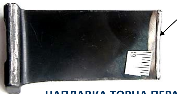
НАПЛАВКА ТОРЦА ПЕРА ЛОПАТКИ
