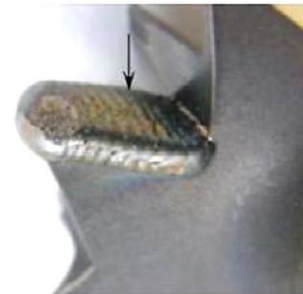
Макроструктура по местам наплавки на лопатке (места наплавки указаны стрелками)
