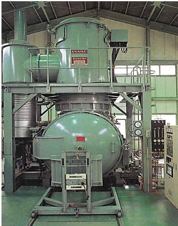
ПЕЧЬ ULVAC С РАБОЧИМ ПРОСТРАНСТВОМ Ø 900 X 900 ММ, ТОЧНОСТЬ ПО ТЕМПЕРАТУРЕ ± 5°C
