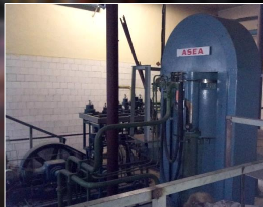
ПРЕСС ГОРЯЧЕГО ИЗОСТАТИЧЕСКОГО ПРЕССОВАНИЯ QIH-40 ФИРМЫ «ASEAMETALLURGY» Габариты садки: диаметр 350 мм, высота 600 мм. Температура в рабочей камере 2000°C Давление газа в рабочей камере 200 МПА
