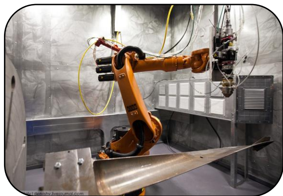
Газотермические методы напыления
