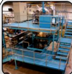
Атомайзер с защитной атмосферой
