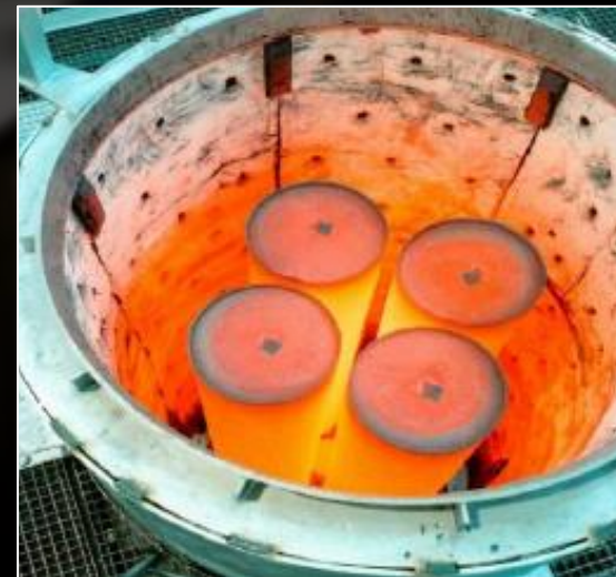
ПРЕСС ГОРЯЧЕГО ИЗОСТАТИЧЕСКОГО ПРЕССОВАНИЯ QIH-40 ФИРМЫ «ASEAMETALLURGY» Габариты садки: диаметр 350 мм, высота 600 мм. Температура в рабочей камере 2000°C Давление газа в рабочей камере 200 МПА
