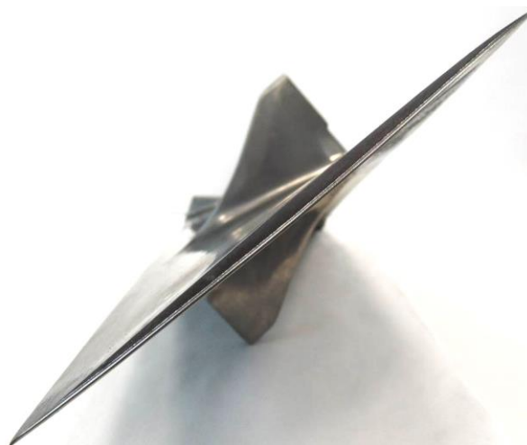
Внешний вид наплавленной «Рабочей лопатки 1 степени»
