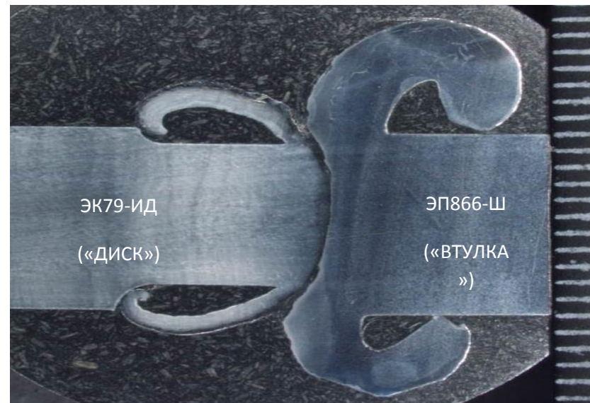
МАКРОСТРУКТУРА СВАРНОГО СОЕДИНЕНИЯ ПОСЛЕ РСТ
